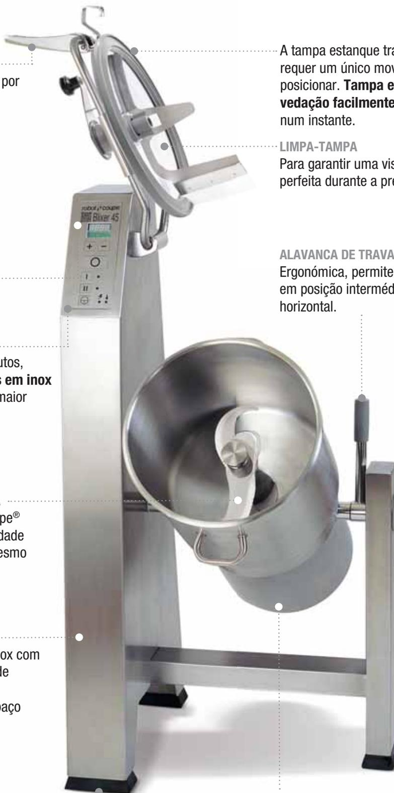
A tampa estanque transparente requer um único movimento para se posicionar. **Tampa e anel de vedação facilmente desmontáveis** num instante.
