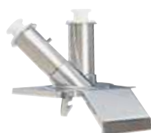
Воронка с прямой и наклонной трубками
